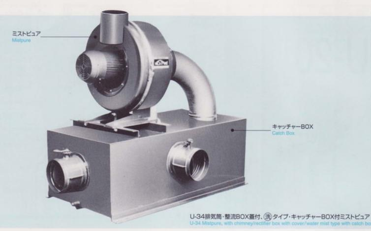
両サイドのエアー流入ロダンバーは、通常全開にして使用していただきますが、 排気に白いものが混じらない程度に、ダンバーを「閉」方向にすることは結構 です。
